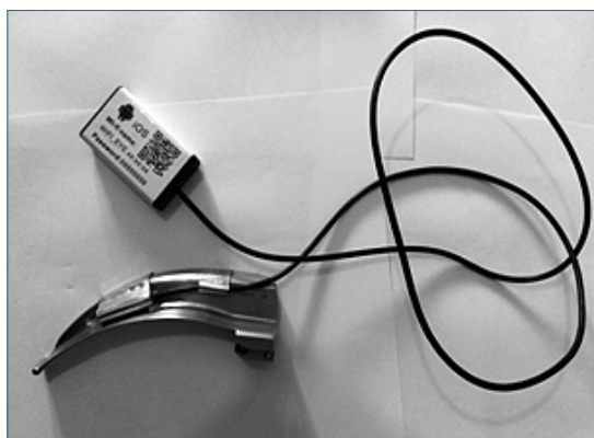
Figura 2. Vista lateral de hoja Macintosh N° 3 con cámara sujeta por broche anterior y posterior.
