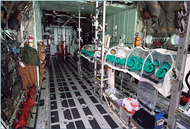
**Figura 5.** Distribución de las cápsulas de aislamiento en Hércules C-130.
