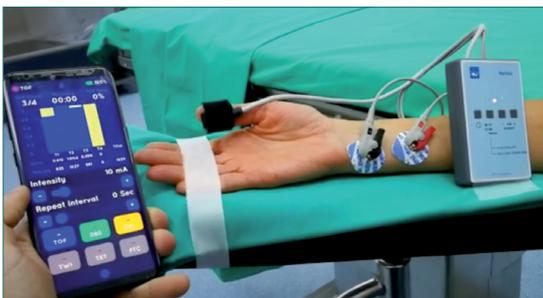
**Figura 8.** El primer prototipo de “iTOF” de “Nerbio”, siendo usado en paciente real.
