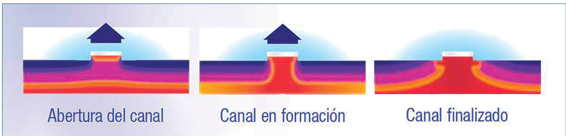
Figura 3. Esquema del funcionamiento de un electrodo de canal de flujo cero de calor: en la imagen de la izquierda el filamento central comienza a producir calor que se transmite a la piel subyacente; en la imagen central existe ya un canal constituido en el que el flujo neto de calor es desde los tejidos subcutáneos hacia el electrodo; en la imagen de la derecha el flujo de calor a través del canal es cero puesto que se igualan los niveles de temperatura. Ese valor es interpretado como la temperatura central del paciente.
