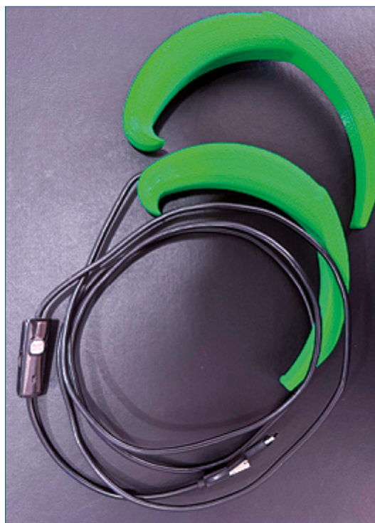
Figura 1. Componentes del videolaringoscopio LarinGo!: hojas impresas en ácido poliláctico (PLA) con micropartículas de cobre y cámara USB conectable a computador portátil.
